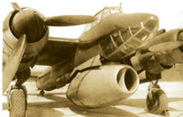
Одна из первых летающих лабораторий Ту-2ЛЛ для испытаний турбореактивных двигателей. 1947 год
