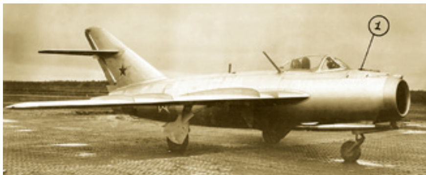
Истребитель МиГ-17 на государственных испытаниях прицела АСП-4Н и радиодальномера «Радаль-М». 1 – антенна радиодальномера
