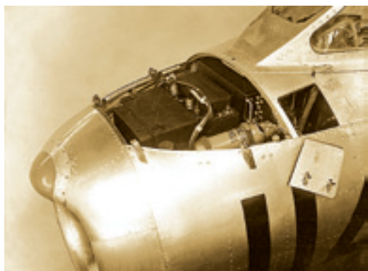
Установка радиодальномера «Град» на истребителе МиГ-17 (СГ)
