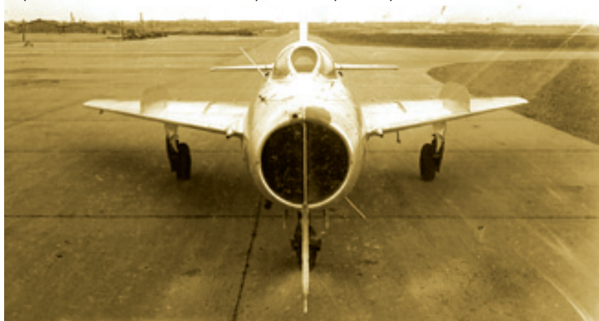
Истребитель МиГ-19С первых серий, оборудованный прицелом АСП-5Н и радиодальнономером СРД-3 «Град», на аэродроме горьковского авиазавода №21
