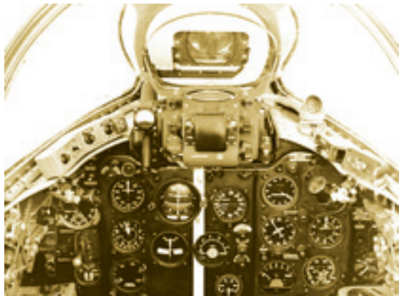
Установка прицела АСП-5Н сопряжённо-го с радиодальнономером СРД-1 «Радаль-М» в кабине истребителя МиГ-17
